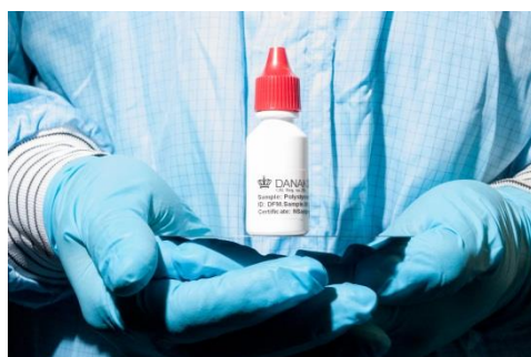
Foto: Flaske med en opløsning af polystyrenpartikler til reference brug. Den gennemsnitlige partikelstørrelse er sporbart udmålt under akkrediteringen
